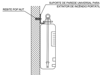
**2 DETALHE 1 - FIXAÇÃO DO EXTINTOR SEM ESCALA**
