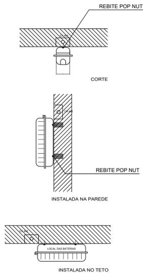
**3 DETALHE 2 - LUMINÁRIA DE EMERGÊNCIA AUTÔNOMA SEM ESCALA**
